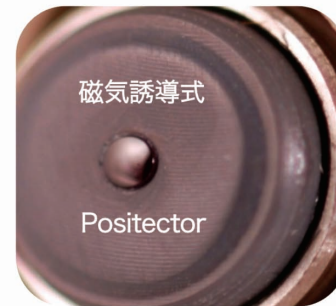
約5万回測定した後のプローブ先端
