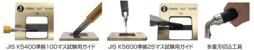
JIS K5400準拠100マス試験用ガイド JIS K5600準拠25マス試験用ガイド 多重刃切込工具
