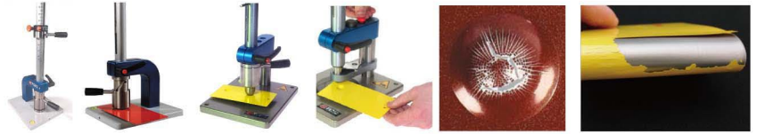
ダイレクトモデル インダイレクトモデルと試験後の塗膜 ヒートサイクル+屈曲試験
