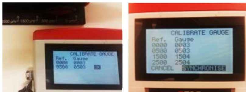
第12図 コントロールユニット における校正実測値の 表示例
