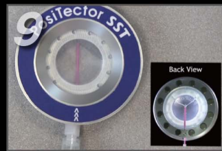
非イオン水をPosiPatchに注入
