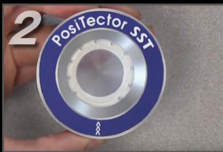
これを素地鋼板に固定します
