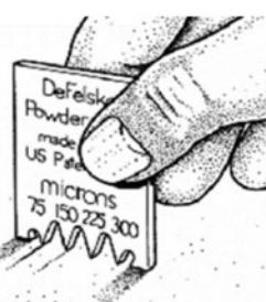
硬化前の粉体層の下の素地に接しさせながらくし形膜厚計を横にすりします。粉体層に残った歯の痕跡を観察し、粉体層の厚みの目安を得ます。
